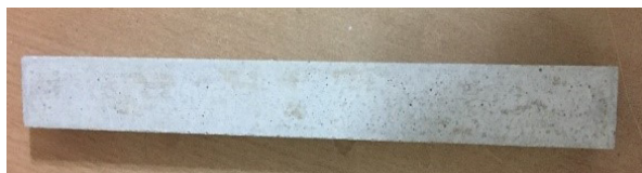
شکل ۳: ساخت ملات جهت آزمون انقباض
