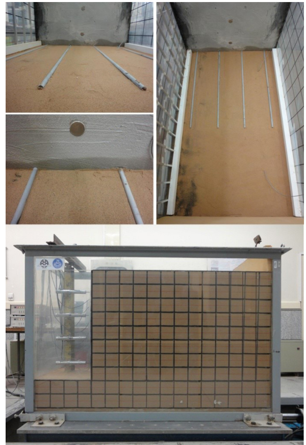
شکل ۱۴: مراحل ساخت و شمای کلی از مدل فیزیکی سیستم خاک میخ کوبی شده بر روی میز لرزه
