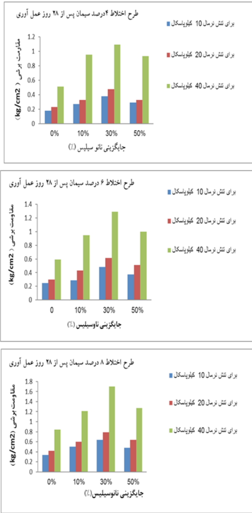
شکل ۴: ب) نمودار تغییرات مقاومت برشی بر حسب جایگزینی نانو سیلیس پس از ۲۸ روز عمل آوری
