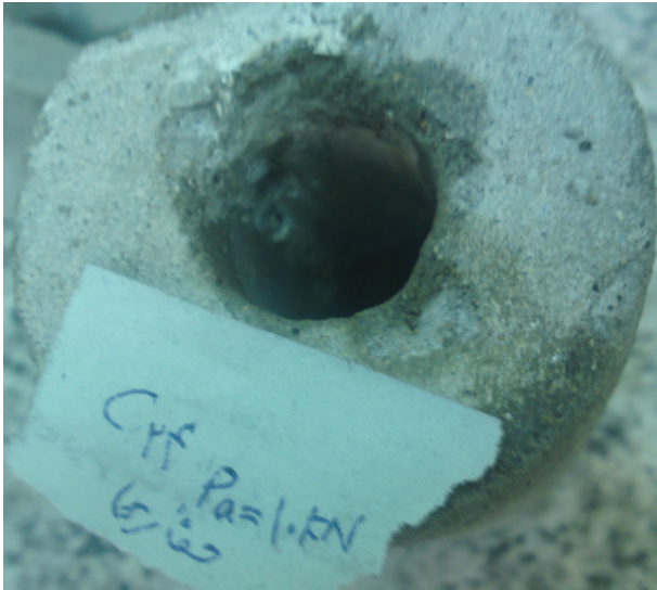
شکل ۱۶: تصویر بعد از شکست نمونه‌های استوانه‌ای جدار ضخیم
