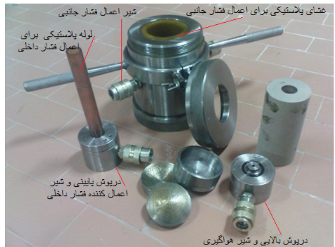
شکل ۳: (الف) نمای کلی از سلول هوک تغییر یافته، (ب) سلول هوک تغییر یافته با نمونه داخل آن در دید از بالا و (ج) اجزای داخلی سلول هوک
