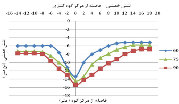
شکل ۱۴: تنش خمشی دیواره-فاصله از مرکز گوه برای مقادیر مختلف زاویه تقاطع
