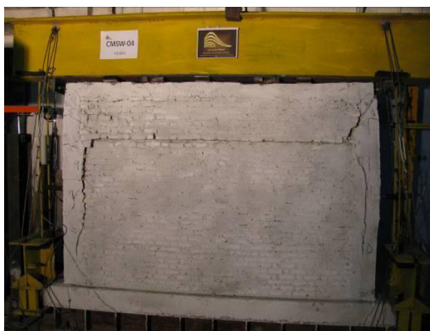
شکل ۷: تصویر نمونه CMSW-04 پس از گسترش ترک‌ها
