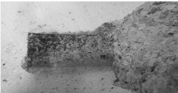
شکل ۱۷: سطح گسیختگی پس از جداسازی در تیرهای تقویت شده سری A در دمای 20^{\circ}\text{C}
