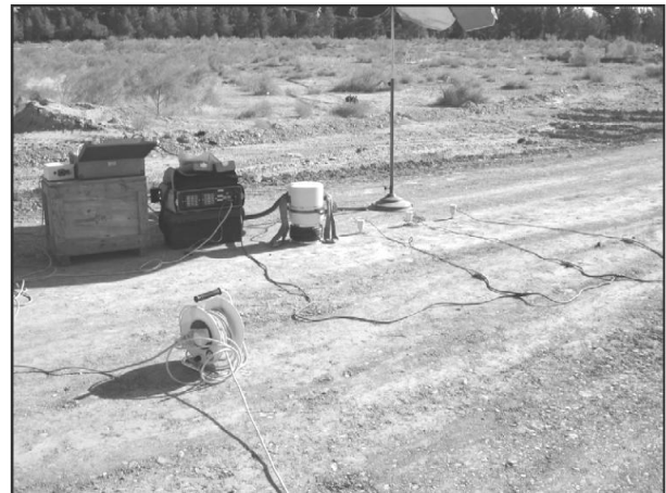
شکل (۷): آزمون امواج سطحی پیوسته در پردیس دانشگاه سمنان (امینی آهی دشتی ۱۳۹۰)
