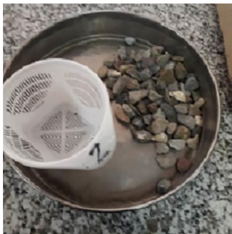
شکل ۱. سنگدانه های با اندازه دانه ۱۲-۱۹ mm پس از آزمایش سلامت سنگدانه (ASTM C88) نمونه خاک اصلاح نشده
