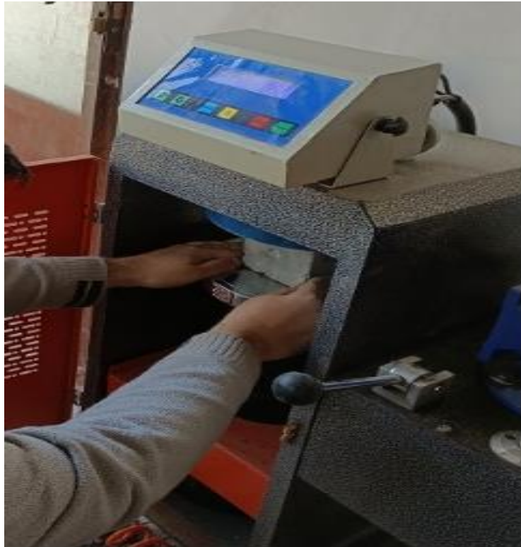
شکل ۶. انجام آزمون مقاومت فشاری
