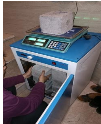
الف) نمونه های بتنی در گرمخانه (a) Concrete samples in the oven
