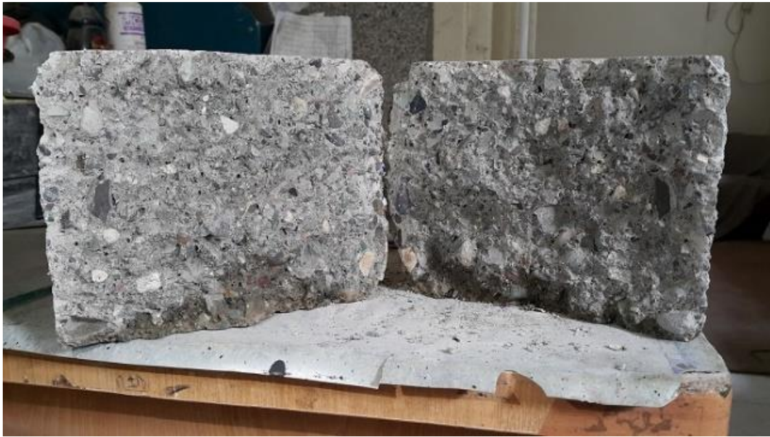
شکل ۱۱. میزان نفوذ آب در نمونه‌ها
