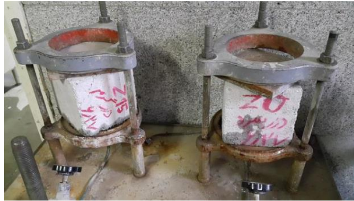
شکل ۸. قرارگیری نمونه‌ها در دستگاه عمق نفوذ آب
