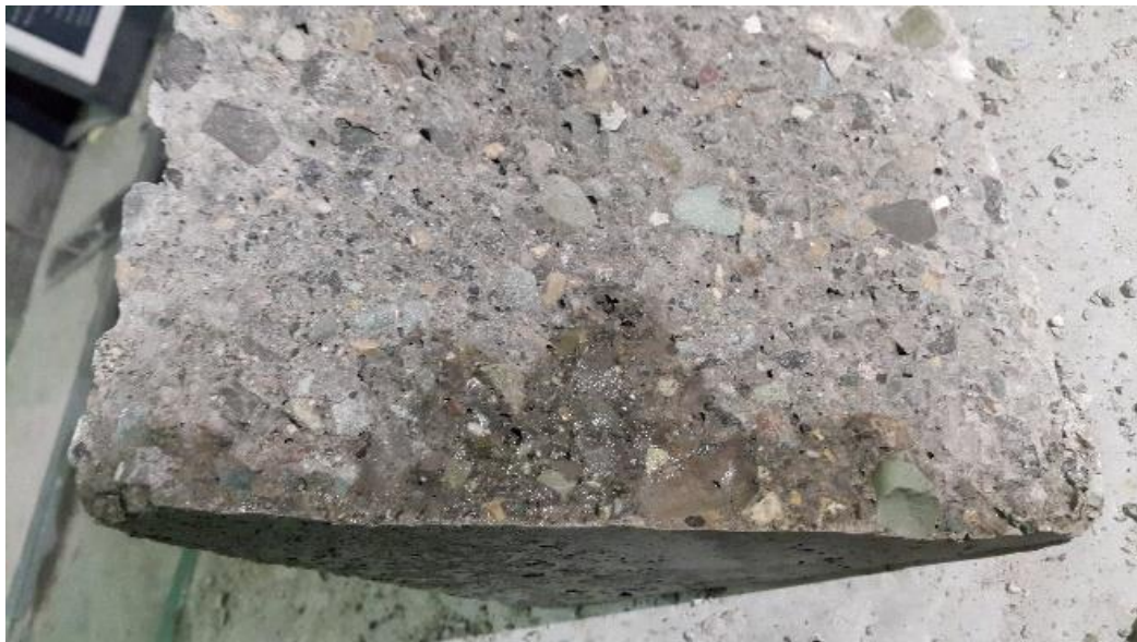
شکل ۱۲. نمای بزرگنمایی شده میزان نفوذ آب در نمونه‌ها
