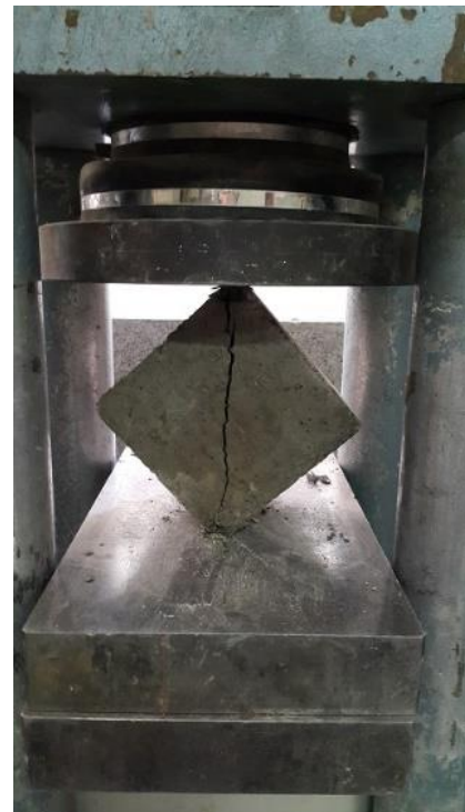
شکل ۹. دو نیم شدن نمونه‌ها توسط دستگاه
