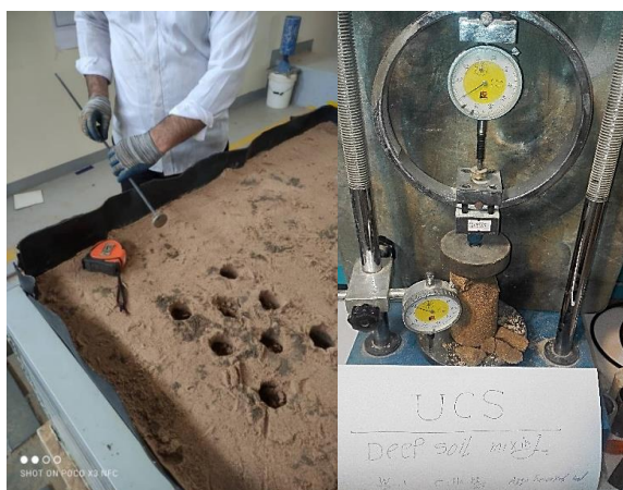
شکل ۴. مقاومت تک محوری ستون‌های اختلاط عمیق DSM
