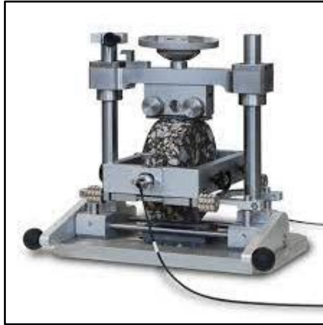
شکل ۲. نمونه تحت بارگذاری در آزمایش خستگی به روش کشش غیرمستقیم
