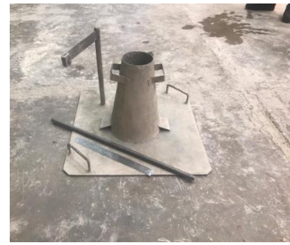
(الف) دستگاه آزمون اسلامپ (a) Slump test device
