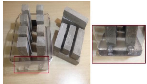
(الف) آزمایش جذب آب موئینه
