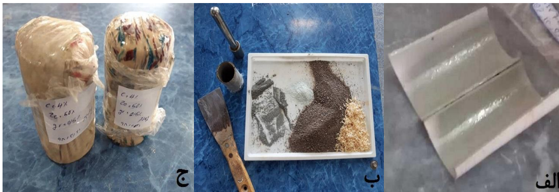
شکل ۶. مراحل ساخت و عمل‌آوری نمونه‌ها - الف) قالب PVC، ب) تجهیزات و اختلاط مصالح ج) عمل‌آوری نمونه‌ها داخل پوشش مرطوب
