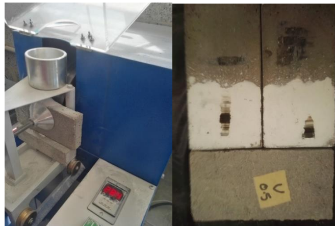
شکل ۵. تست سایش بر روی نمونه‌های بتنی مورد آزمایش
