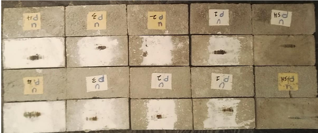
شکل ۳. نمونه های بتنی آغشته به لایه های پوششی نانو اکسید آلومین رقیق شده
