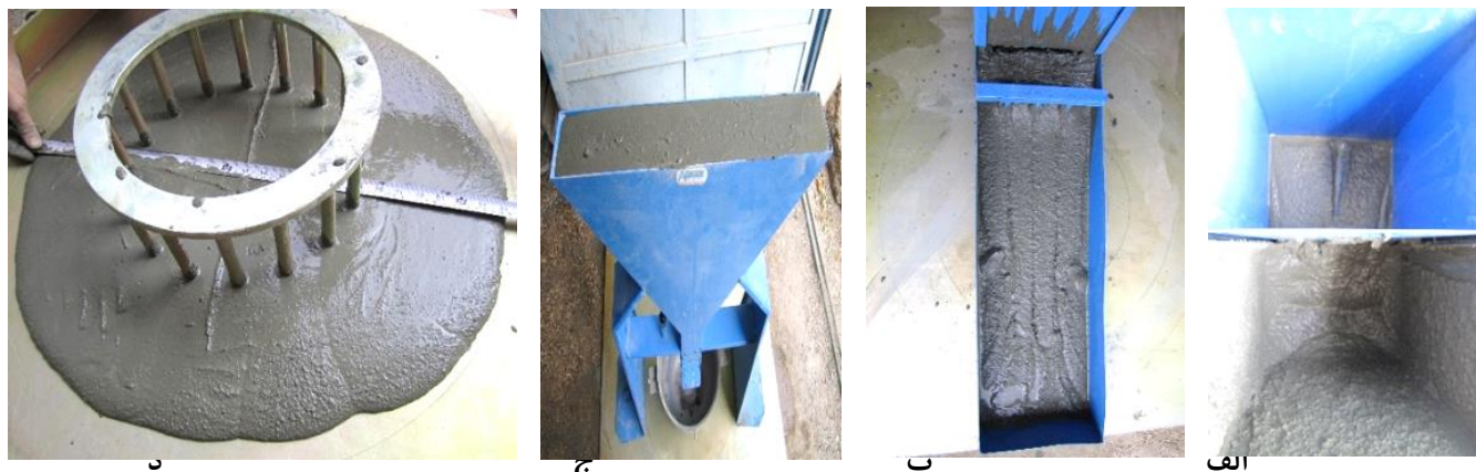
شکل ۵. آزمایش‌های. (الف) جعبه U، (ب) جعبه L، (ج) قیف V، (د) حلقه J
