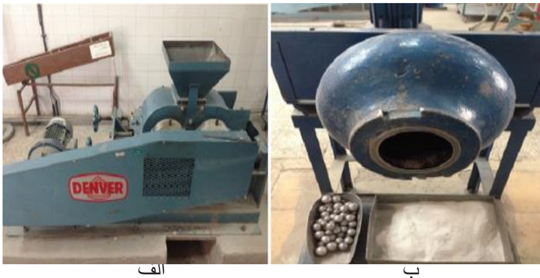
شکل ۲. فرآیند تولید پودر شیشه توسط (الف) دستگاه سنگ شکن (ب) آسیاب سیاره‌ای
