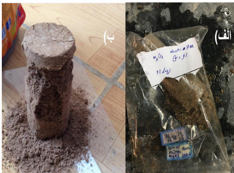
شکل ۹. الف) تخریب خود به خودی نمونه ۹۱ روزه M7G9 ب) تخریب خود به خودی نمونه M8G9 در زمان کوتاهی پس از ساخت
