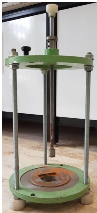
شکل ۳. دستگاه ساخت نمونه روش تراکم کاهش یافته با چکش قابل تنظیم
