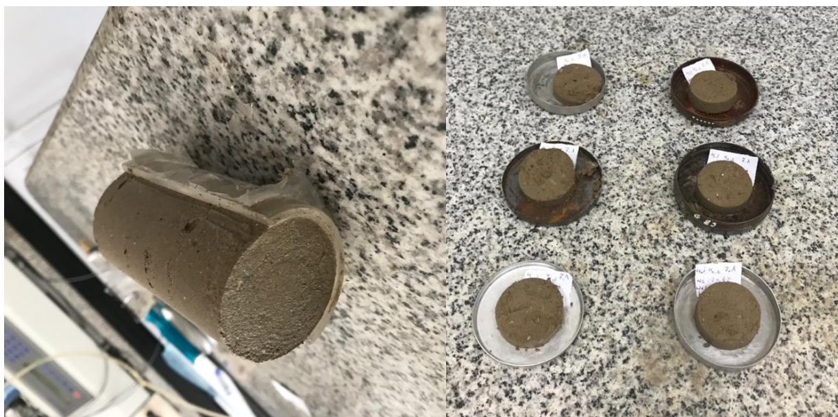
شکل ۵. نمونه تزریق شده به همراه نمونه‌های بریده شده
