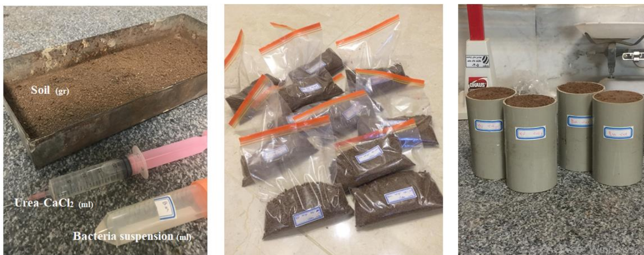
شکل ۴. مراحل ساخت نمونه به روش اختلاط
