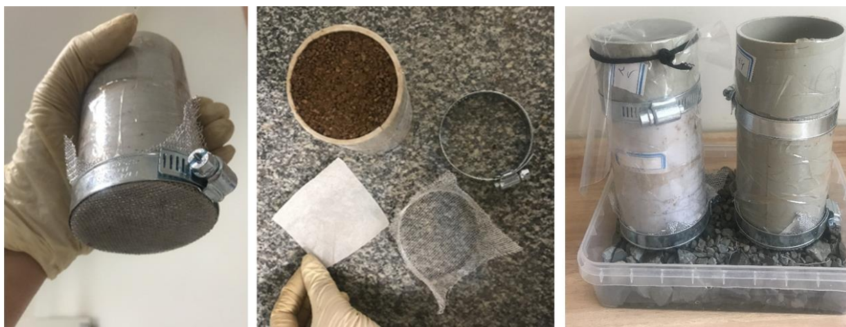
شکل ۵. مراحل ساخت نمونه به روش جذب سطحی
