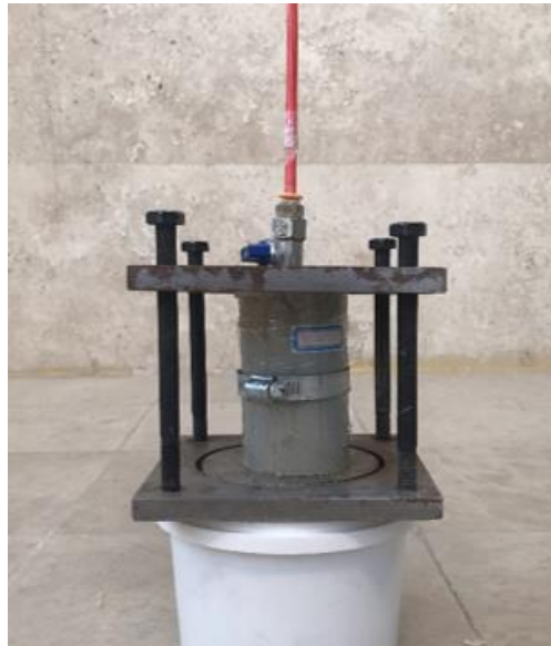
شکل ۶. ساخت نمونه به روش تزریق با فشار
