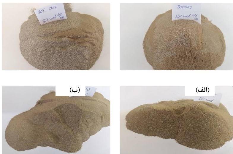
شکل ۳. تصویر چهار نوع مصالح مخلوط شده شامل الف) ۵۰٪ ماسه + ۱۵ mm و ۵۰٪ رس، ب) ۸۰٪ ماسه + ۱۵ mm و ۲۰٪ رس، پ) ۵۰٪ ماسه + ۲۵ mm و ۵۰٪ رس و ت) ۸۰٪ ماسه + ۲۵ mm و ۲۰٪ رس
