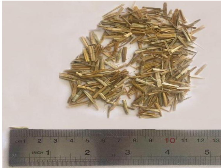
شکل ۲. الیاف کوتاه شده ساقه برنج به طول ۱ cm و قطر میانگین ۰/۲ cm.
