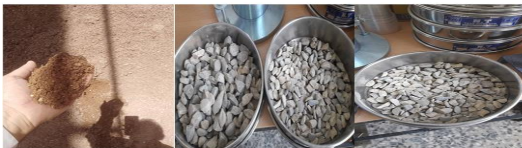
شکل ۶. مصالح سنگی (شن ۵-۲۵ میلی‌متر) و (ماسه ۰-۵) شسته دو بار شور مورد استفاده - شهرستان شوشتر - ایران Fig. 6. Aggregate (5-25 mm sand) and (0-5 sand) washed twice salt used - Shushtar city - Iran
