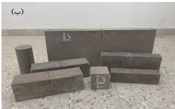
شکل ۶. (الف) دستگاه آزمایش (ب) تعدادی از نمونه‌های ساخته شده
