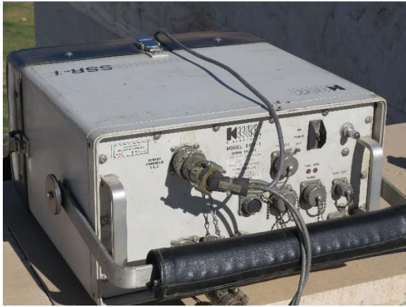
ب) دستگاه جمع کننده اطلاعات SSR-1 b. SSR-1 data logger
