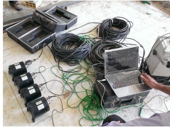
الف) کالیبره کردن حسگرهای لرزه سنج رنجر مدل SS-1 a. SS-1 Ranger Seismometer sensors calibration
