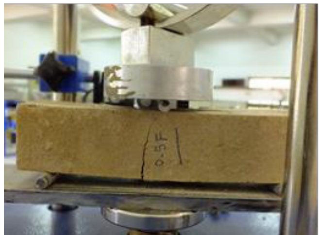
شکل ۶. یک نمونه مکعب مستطیلی تحت آزمایش خمش سه نقطه ای
