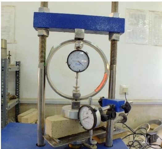
شکل ۶. یک نمونه مکعب مستطیلی تحت آزمایش خمش سه نقطه ای
