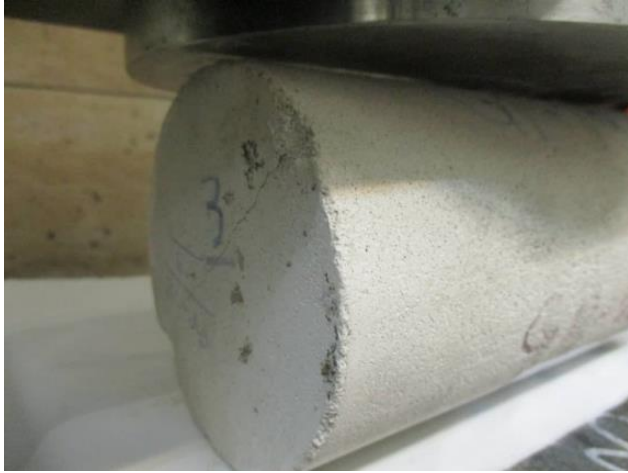
ب) شکست نمونه حاوی نانوگرافن
