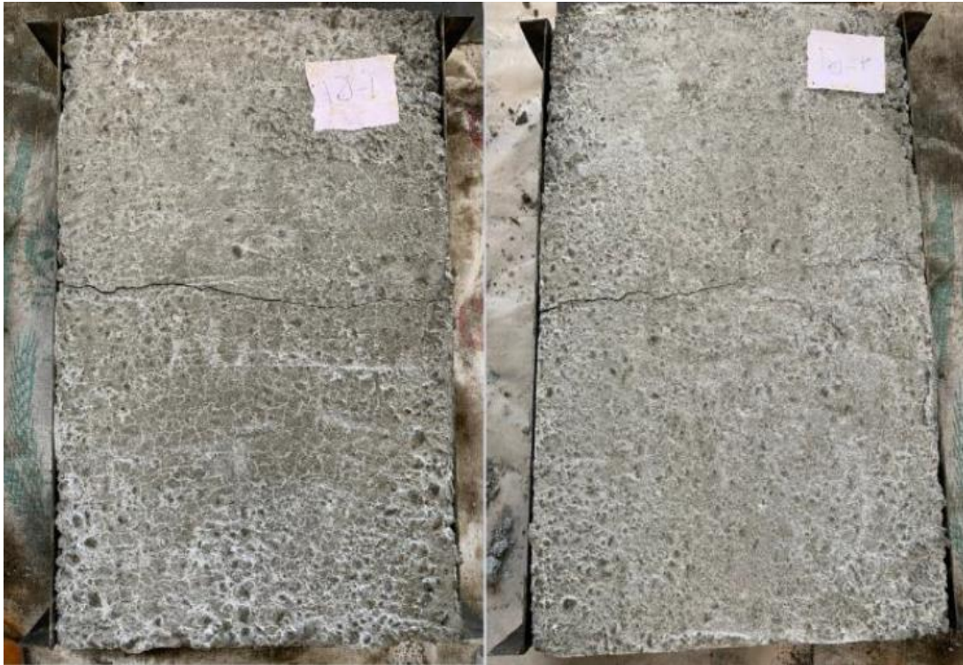
شکل ۸. نمونه‌های آزمایش شده دال بتن روسازی هوادار در انتهای آزمایش
