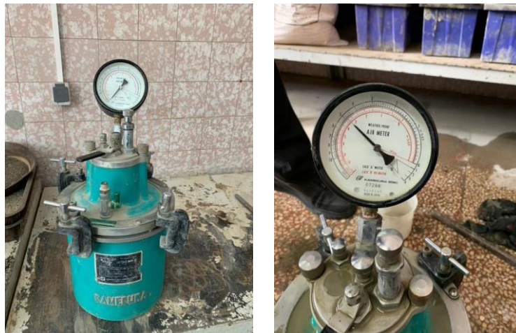
شکل ۲. آزمایش تعیین مقدار هوای بتن تازه به روش فشاری مطابق با استاندارد ASTM C231
