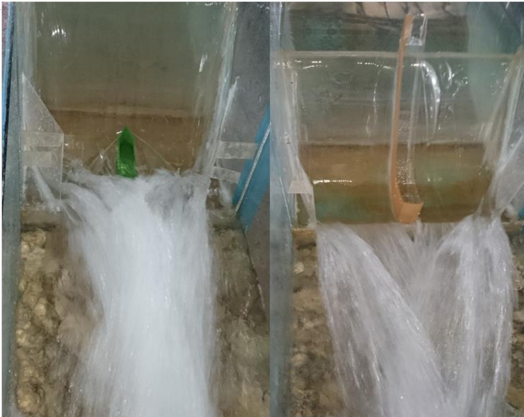
شکل ۱. پرتاب کننده جامی همگرا با دیواره جداکننده در جام و دیواره جداکننده سرتاسری Fig. 1. Converged bucket with the splitter wall in the bucket and the overall splitter wall
