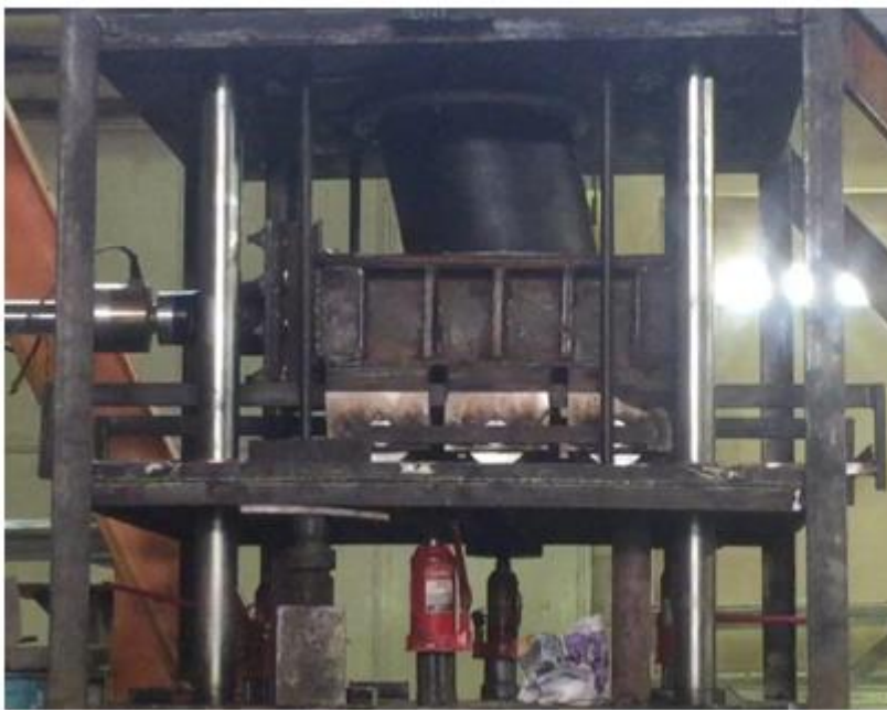
شکل ۱۰. جداگر الاستومری در مطالعات حکیمیان- تقی خانی به همراه مدل آزمایشگاهی و اجزای محدود آن [۴]
