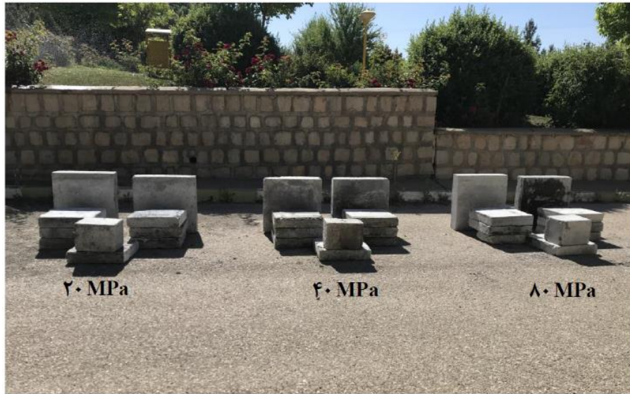
شکل ۲. بتن‌های مادر با رده‌های مقاومتی ۲۰، ۴۰ و ۸۰ مگاپاسکال.
