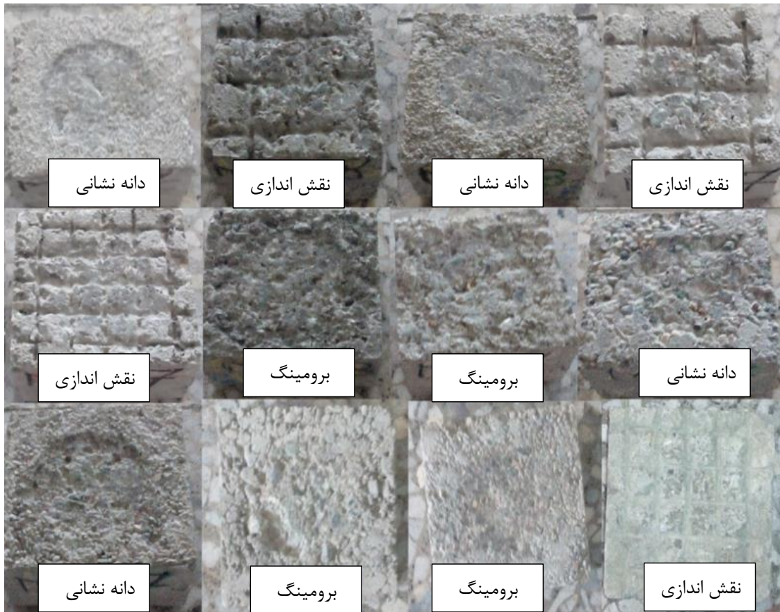
شکل ۸. نمایش نمونه‌ها بعد از آزمون سایش
