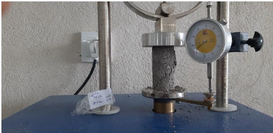
شکل ۴. تصویری از نمونه گسیخته شده پس از انجام آزمایش
