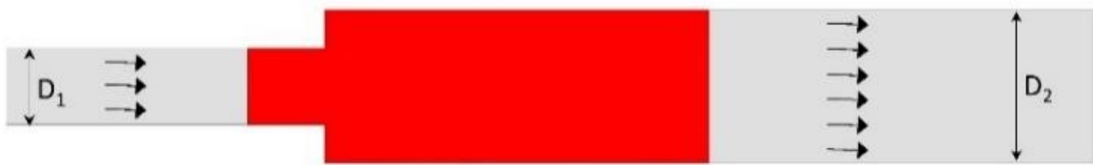
شکل ۲۷. ناحیه مورد استفاده جهت مدل سازی عددی بازشدگی ناگهانی
