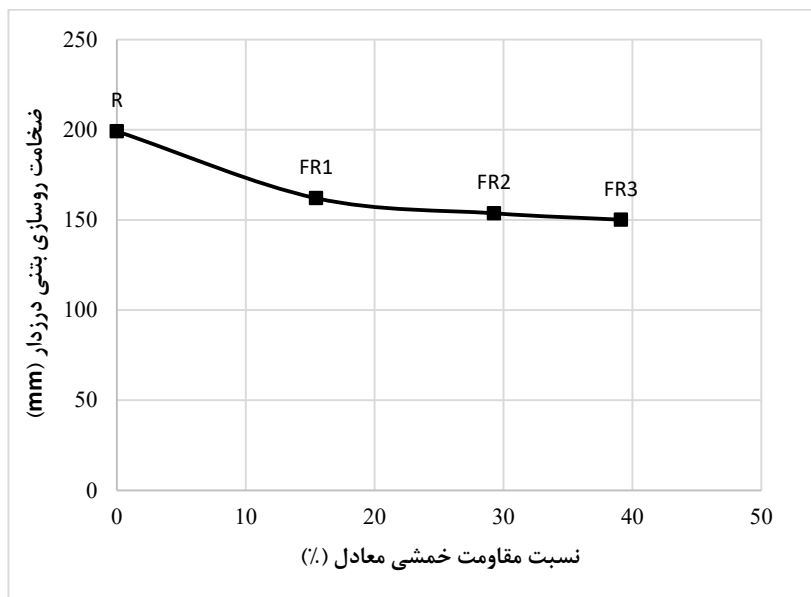
شکل ۱۱. تغییرات ضخامت نسبت به نسبت مقاومت خمشی معادل روسازی بتنی درزدار ساخته شده با طرح‌های اختلاط بتن شاهد و الیافی Fig. 11. Changes of thickness relative to equivalent flexural strength ratio of jointed concrete pavement fabricated with reference and fiber-reinforced concrete mixtures
