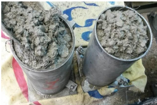
شکل ۴. ساخت نمونه‌های استوانه‌ای جهت تعیین مقاومت فشاری بتن مطابق با استاندارد ASTM C39
