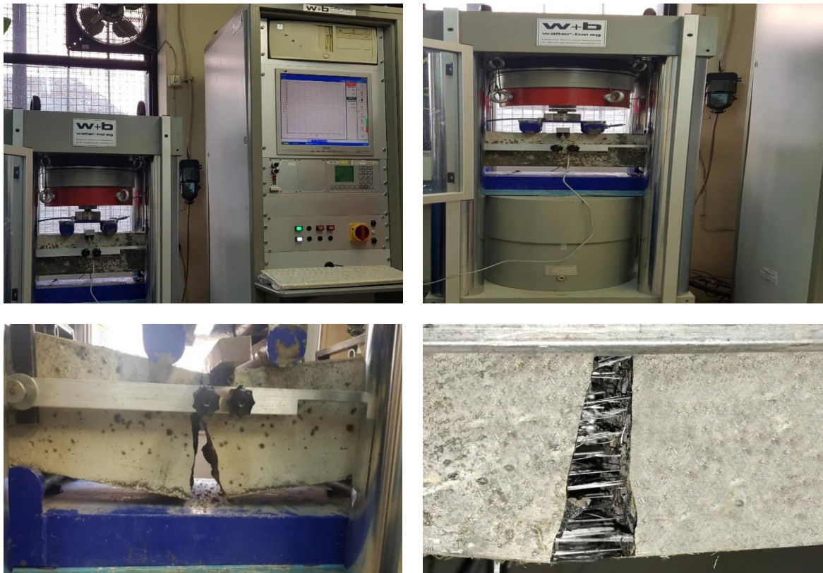
شکل ۷. تعیین عملکرد خمشی تیرهای بتنی مطابق با استاندارد ASTM C1609
