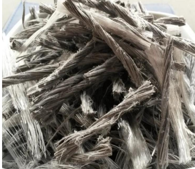
شکل ۱. الیاف ماکروسینتتیک مورد استفاده در این تحقیق Fig. 1. Macro synthetic fibers used in this study
