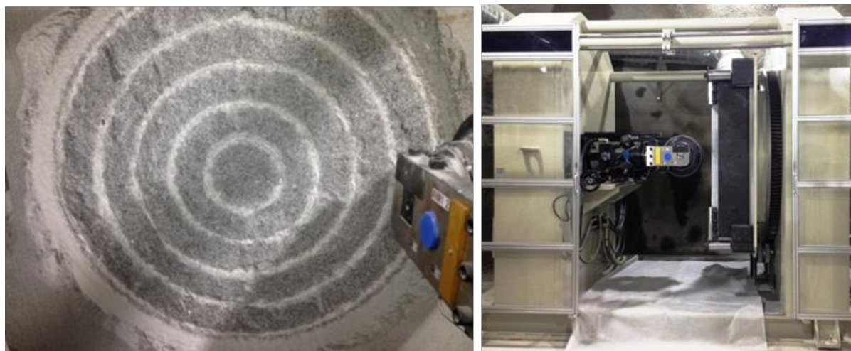
شکل ۲. آزمایش بزرگ مقیاس برش دورانی برای تعیین پارامترهای بهینه هندسه برش [۱۳]
