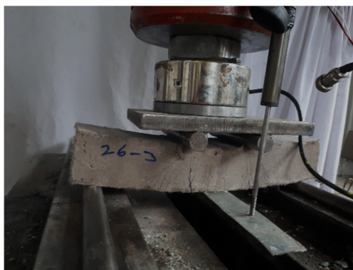
شکل ۱. آزمایش خمش چهار نقطه ای Fig. 1. Four-point bending test
