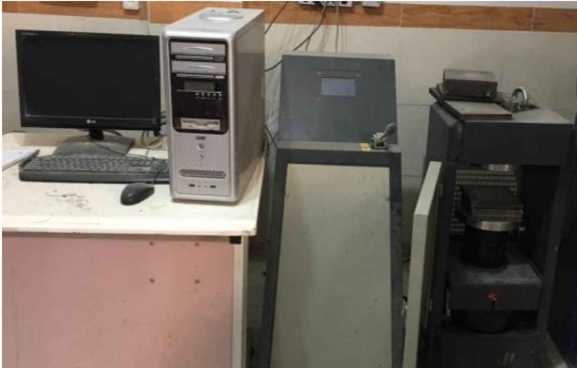
شکل ۲. جک فشاری به ظرفیت ۳۰۰۰ کیلو نیوتن برای انجام آزمایش‌ها
