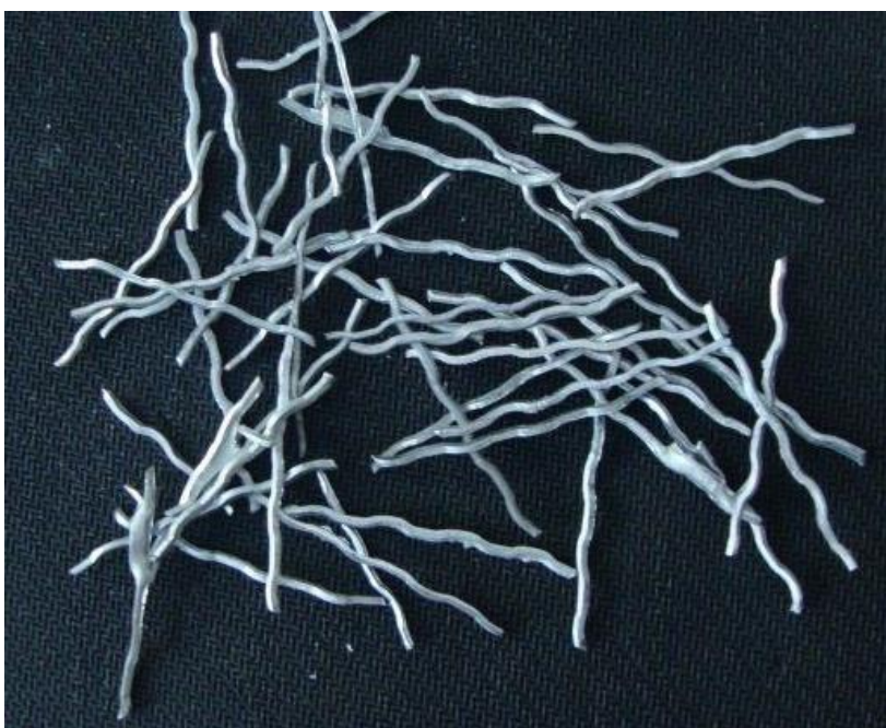
شکل ۱. الیاف فولادی مورد استفاده در نمونه‌های SFRC
