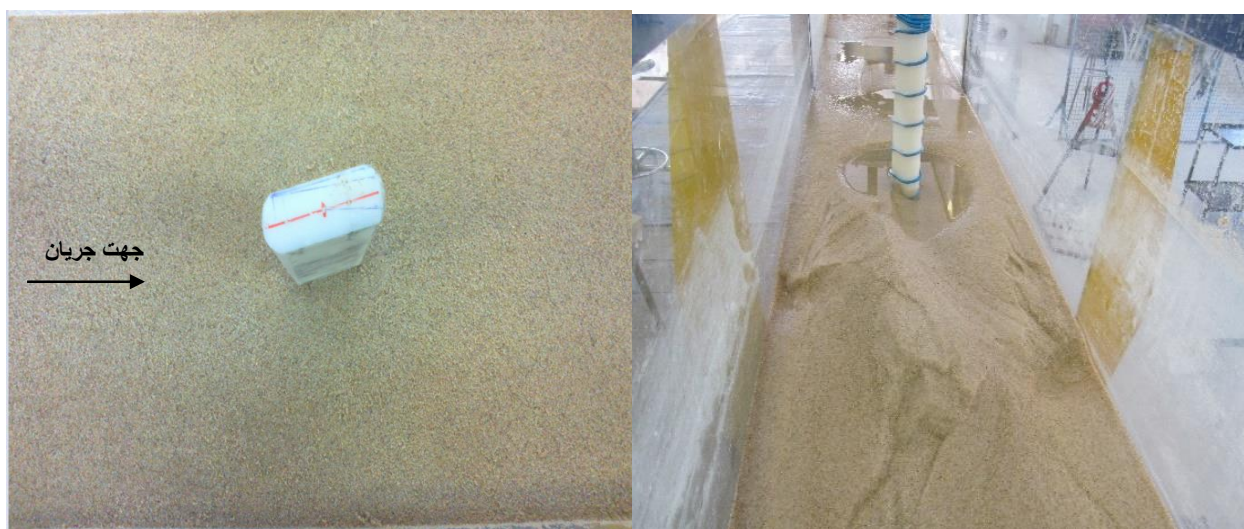
شکل ۱۱. عمق نهایی آبستگي پایه نوع سوم در زاویه برخورد ۱۵ درجه در موقعیت پایین دست و نحوه اعمال تغییر زاویه
