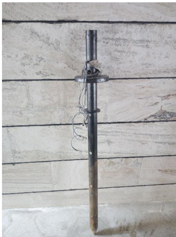
شکل ۴. دستگاه ساخته شده برای اندازه گیری دما در اعماق مختلف بستر رودخانه
