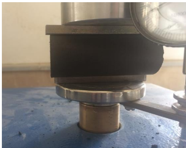
شکل ۶. چگونگی قرارگیری نمونه در دستگاه برای تعیین مقاومت کششی Fig. 6. Sample placement in the machine to determine tensile strength
