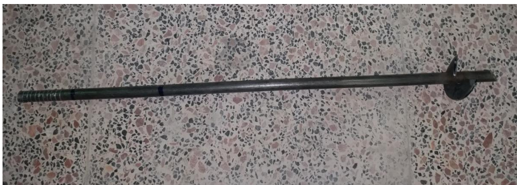
شکل ۷. شمع پیچشی با گام ۵/۲ سانتی‌متر Fig. 7. The helical pile with a pitch of 2.5 cm
