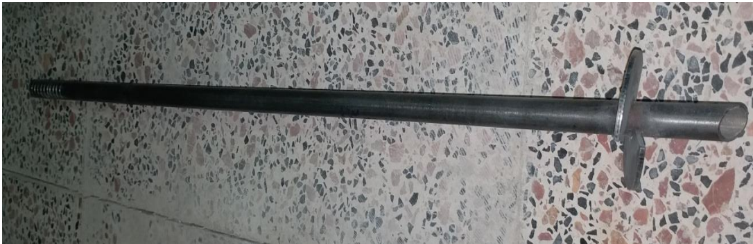
شکل ۵. شمع پیچشی با گام ۳/۱ سانتی‌متر Fig. 5. The helical pile with a pitch of 1.3 cm
