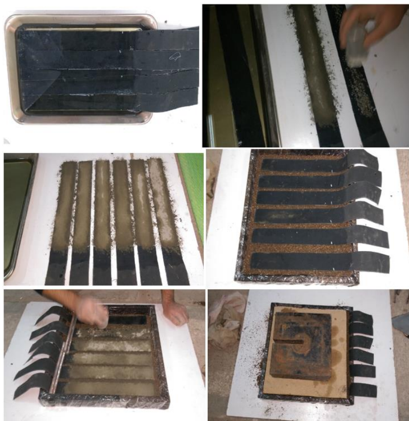
شکل ۳: مراحل تهیه نمونه های ژئوتکستایل های سیمان شده Fig. 3. Cement treatment of the surfaces of geotextile specimens.
