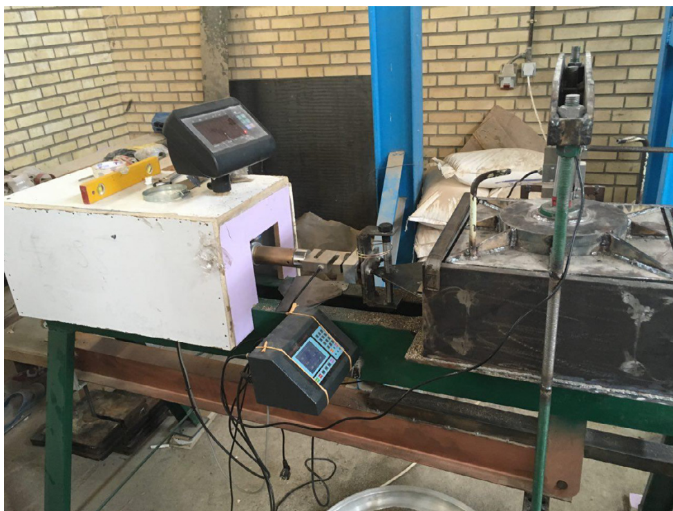
شکل ۱: دستگاه بیرون کشیدن ژئوتکستایل Fig. 1. Pullout test setup.
