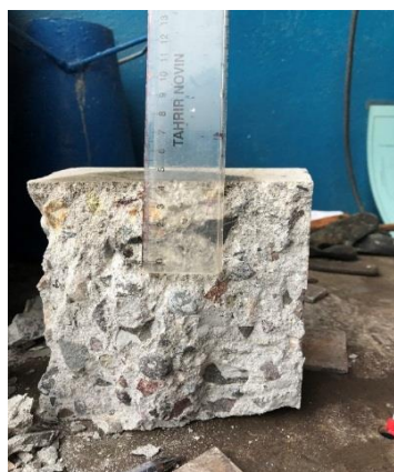
شکل ۱۶. اندازه‌گیری عمق نفوذ آب Fig. 16. Measuring the Depth of water penetration
