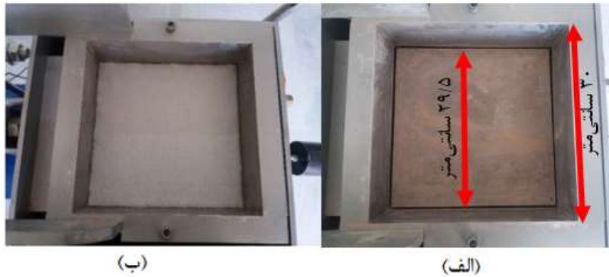
شکل ۶: (الف) قرارگیری بلوک چوبی در جعبه‌ی برش. (ب) بعد از نصب ژئوتکستایل
