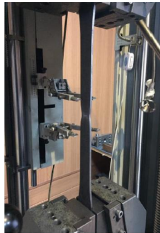
شکل ۴. نمونه‌ی فولادی استخوانی شکل استاندارد تحت آزمایش کشش تک‌محوره Fig. 4. Standard shaped bony steel specimen under uniaxial tensile test
