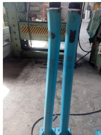
شکل ۳۳. نمونه‌های پر شده با بتن ساده و الیافی بعد از بارگذاری بدون خروج از مرکزیت
