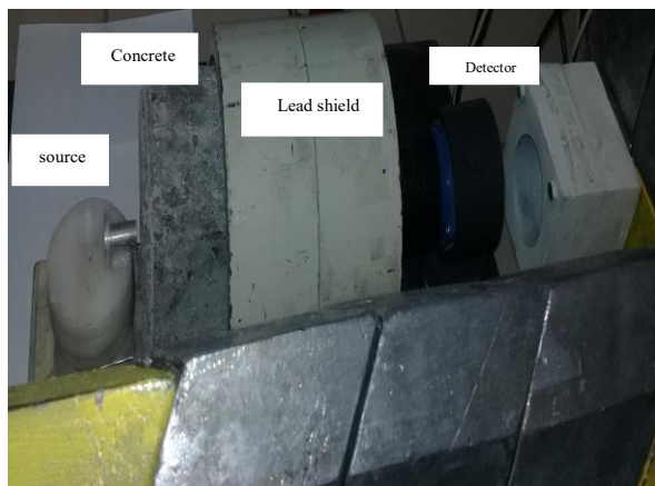
شکل ۴. چیدمان آزمایش پرتو دهی به بتن توسط چشمه گاما و شمارش توسط آشکار ساز NaI(Tl)
