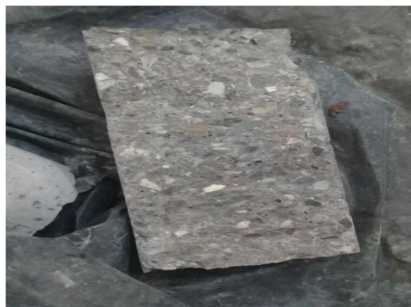
شکل ۳. تصویر نمونه دو نیم شده استوانه‌ای تحت آزمایش شکافت برزیلی
