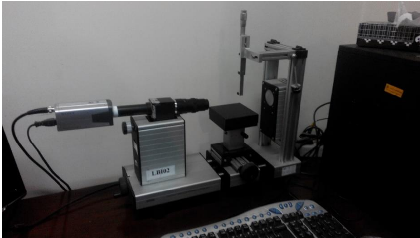
شکل ۷. قسمت‌های مختلف دستگاه آزمایش قطره چسبان Fig. 7. Different parts of the sessile drop test
