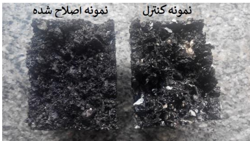
شکل ۱۲. مقایسه بین گسیختگی ایجاد شده در نمونه‌های کنترل و اصلاح شده Fig. 12. Comparison between failure in control and modified specimens
