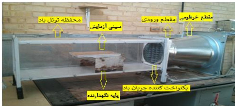
شکل ۲. تونل باد ساخته شده Fig. 2. Wind tunnel built
