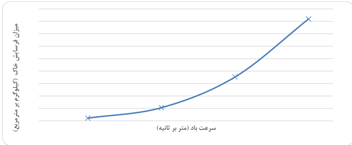
شکل ۵. مقدار فرسایش نمونه خاک تیمارنشده در سرعت‌های مختلف Fig. 5. Erosion rate of untreated soil samples at different velocities
