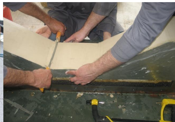
شکل ۶. برش مقطع کانال به کمک قالب، تیغه فلزی و سیم بسیار نازک Fig. 6. shaping of the canal section with template and thin string of wire
