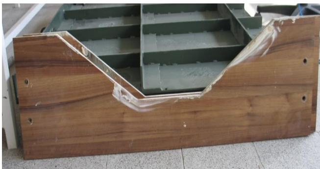
شکل ۶. برش مقطع کانال به کمک قالب، تیغه فلزی و سیم بسیار نازک Fig. 6. shaping of the canal section with template and thin string of wire
